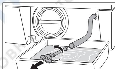
6. Когда вода перестанет литься, открутите крышку фильтра и извлеките его. Всегда держите под рукой тряпку, чтобы вытереть воду, которая может пролиться при снятии фильтра.
